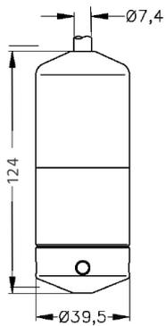
Vorbereitet für Montage mit Edelstahlrohr:
