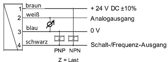
Es wird empfohlen, abgeschirmtes Kabel zu verwenden, Leitungslänge < 30m, Versorgungsleitungen < 10m.
