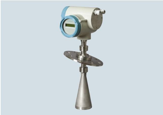
SITRANS LR460 ist ein 24 GHz FMCW-Radar-Füllstandmessumformer in Vierleitertechnik für Messbereiche bis 100 m (328 ft). Er arbeitet mit sehr hohem Rauschabstand und erweiterter Signalverarbeitung für die kontinuierliche Überwachung von Schüttgütern. Er eignet sich ideal für die Messung bei extremem Staub.
