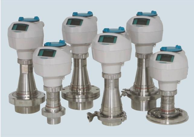
SITRANS LR250 mit gekapselter Antenne mit Hygieneanschluss ist ein 25 GHz Pulsradar-Füllstandmessumformer in Zweileiter-Technik für Messbereiche bis 20 m (66 ft) (je nach Antennentyp). Er besitzt sanitäre und hygienische Zulassungen und eignet sich für die kontinuierliche Überwachung von Flüssigkeiten, Schlämmen und Pasten in den Bereichen Nahrungs- und Genussmittel, Chemie und Pharma (Bild zeigt Geräte mit separat zu bestellendem Zubehör).
