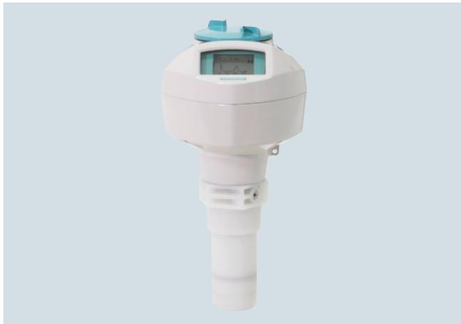
SITRANS LR250 mit PVDF-Antenne und Gewindeanschluss ist ein 25 GHz Pulsradar-Füllstandmessumformer in Zweileiter-Technik für Messbereiche bis 10 m (32.8 ft), bzw. 20 m (66 ft) bei Einsatz in einem Schwallrohr. Er eignet sich für die kontinuierliche Überwachung von Flüssigkeiten und Schlämmen in Lager- und Prozessbehältern mit korrosiven oder aggressiven Materialien.
