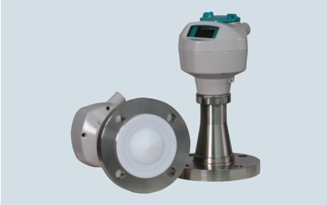
SITRANS LR250 mit gekapselter Antenne mit Flanschanschluss ist ein 25 GHz Pulsradar-Füllstandmessumformer in Zweileiter-Technik für Messbereiche bis 20 m (66 ft) (je nach Antennentyp). Er eignet sich für die kontinuierliche Überwachung von Flüssigkeiten und Schlämmen in Lager- und Prozessbehältern mit korrosiven oder aggressiven Materialien.
