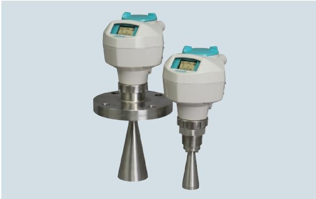
SITRANS LR250 ist ein 25 GHz Pulsradar-Füllstandmessumformer in Zweileiter-Technik für Messbereiche bis 20 m (66 ft). Er eignet sich für die kontinuierliche Überwachung von Flüssigkeiten und Schlämmen in Lager- und Prozessbehältern, auch bei hohen Temperaturen und Druck.
