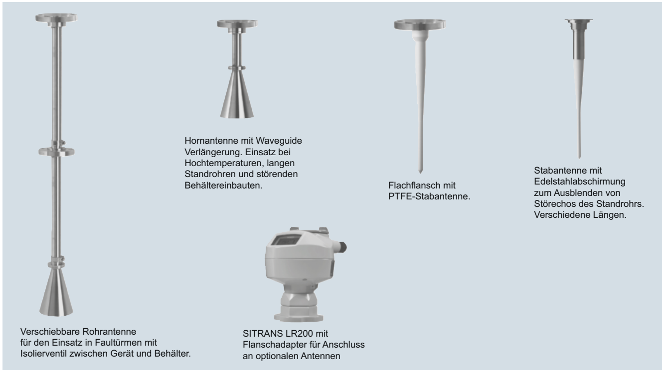
Antennenkonfigurationen für SITRANS LR200
